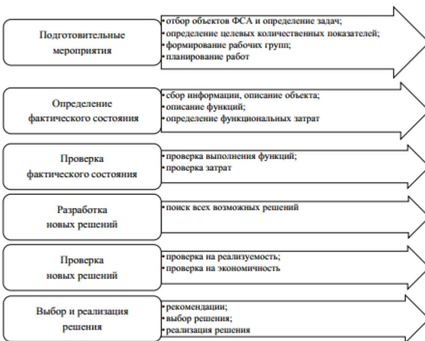
**Рисунок 7. План проведения функционально-стоимостного анализа в соответствии со стандартом DIN 69910**
